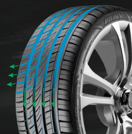
Продольные канавки и акватрени в боковых областях шины обеспечивают отличный отвод воды из пятна контакта шины с дорожным полотном.
